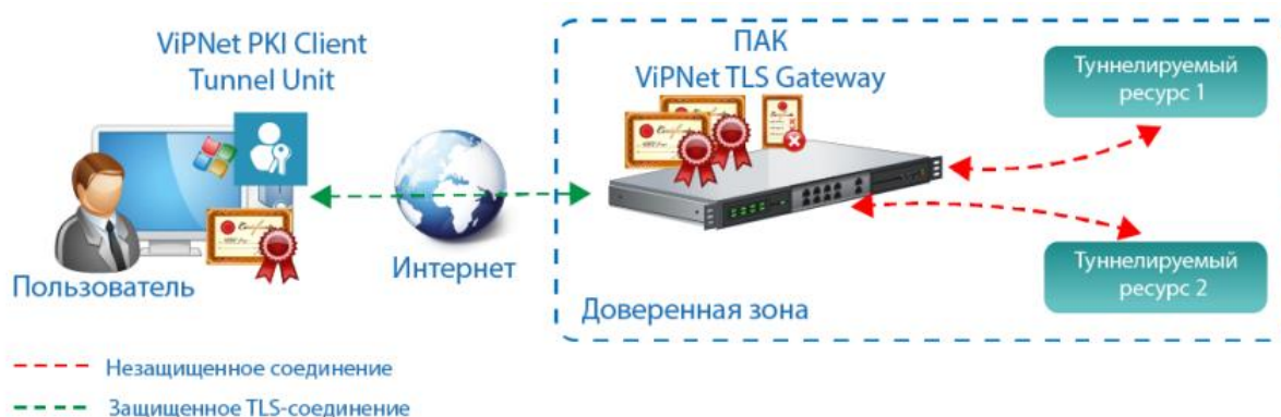
Рисунок 7. Установка соединения с туннелируемыми ресурсами
